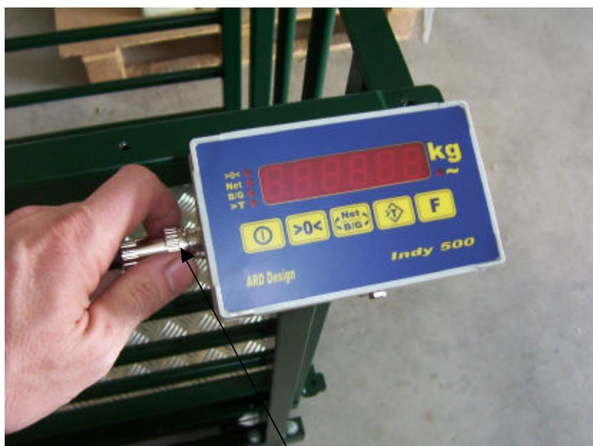
Brancher le connecteur du chargeur sur l'indicateur, puis raccorder le secteur 220VAC
